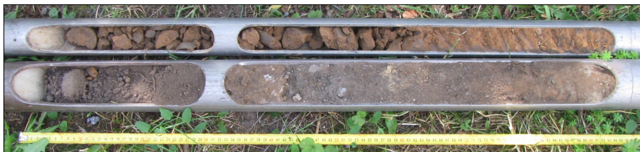
jádro sondy ZS1 - sprašové hlíny GT2 pevné až tvrdé konzistence, které budou ve většině tvořit základovou půdu navrženého pavilonu
